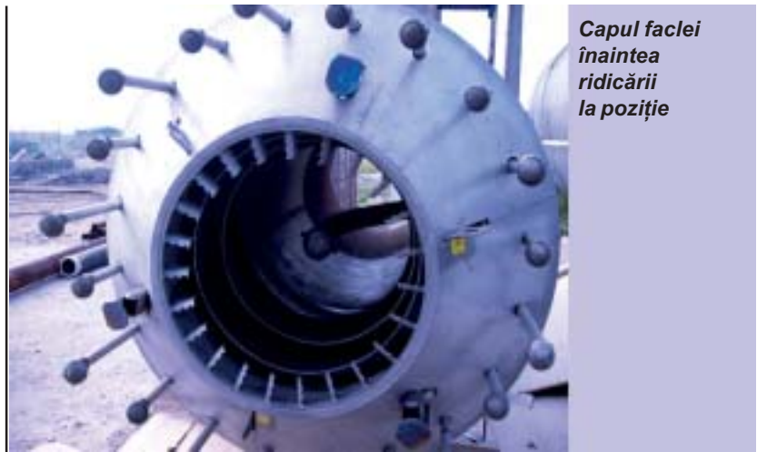
Baza capului de faclă cu racordurile necesare
